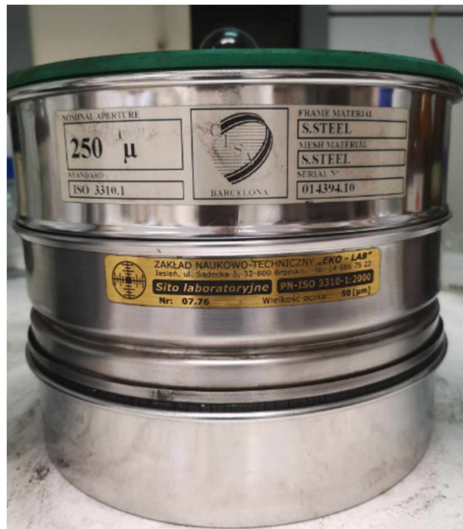
Rys. 17. Sita używane do przesiewania węgla brunatnego
