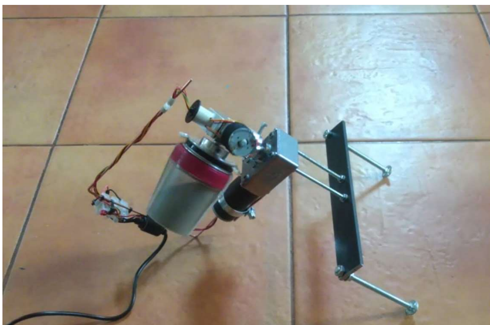
Rys. 19. Mieszadło planetarne – konstrukcja AGH
